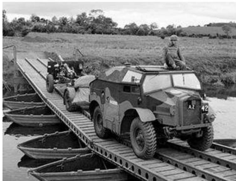
Afb. 4.24 – Een 25 pponder op transport, getrokken door een FAT (Field Artillery Tractor) voorzien van een munitietrailer. 69
